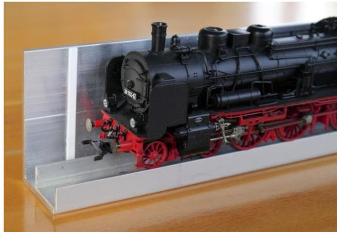
Ende der Lehre mit zusätzlichem Prüf-Fühler (0,5 mm)
