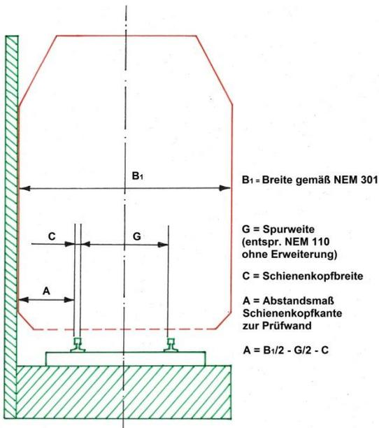
Möglicher Querschnitt einer Prüflehre
