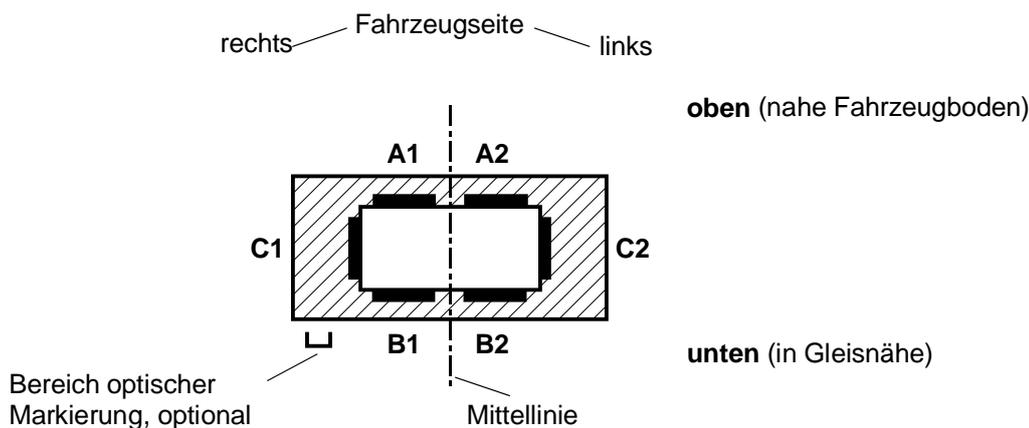
**Anmerkung 1:** Die Vorderansicht der Kupplungsaufnahme am Fahrzeugende 2 des Fahrzeuges ist spiegelsymmetrisch zur Mittellinie in Abb.1 (d. h. die Seitenzuordnungen der Kontakte bleiben erhalten)!
