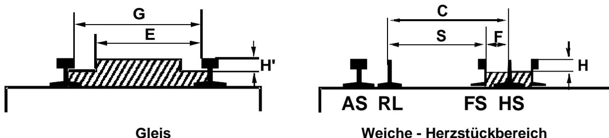
Die waagerechten Maße dieser Norm werden an den senkrechten Kanten der Schienenprofile gemessen.
